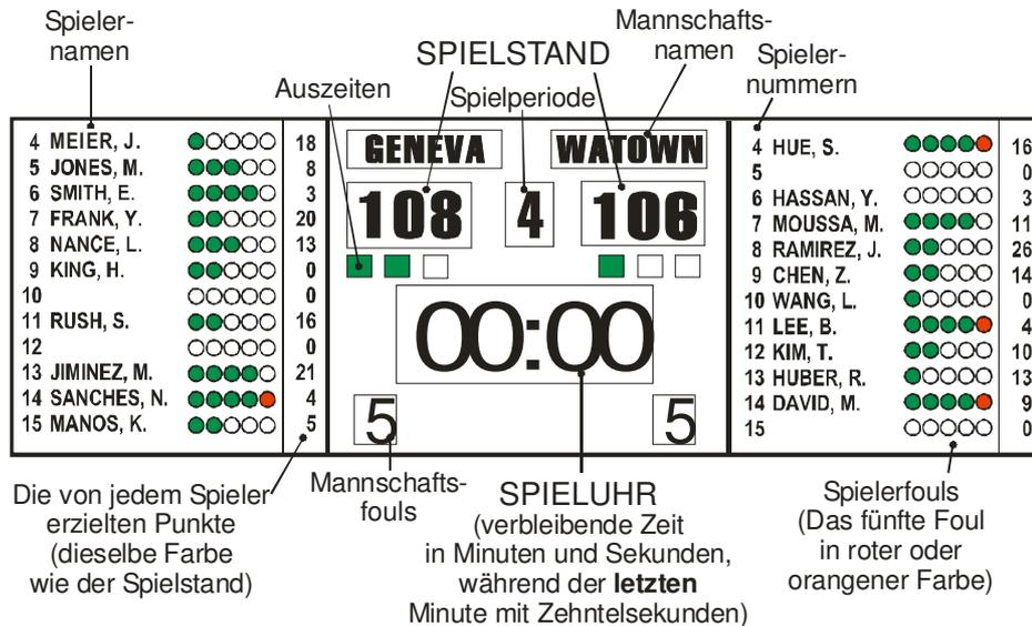
**Bild 8 Anzeigetafel für Wettbewerbe der Stufe 1 (Beispiel)**
