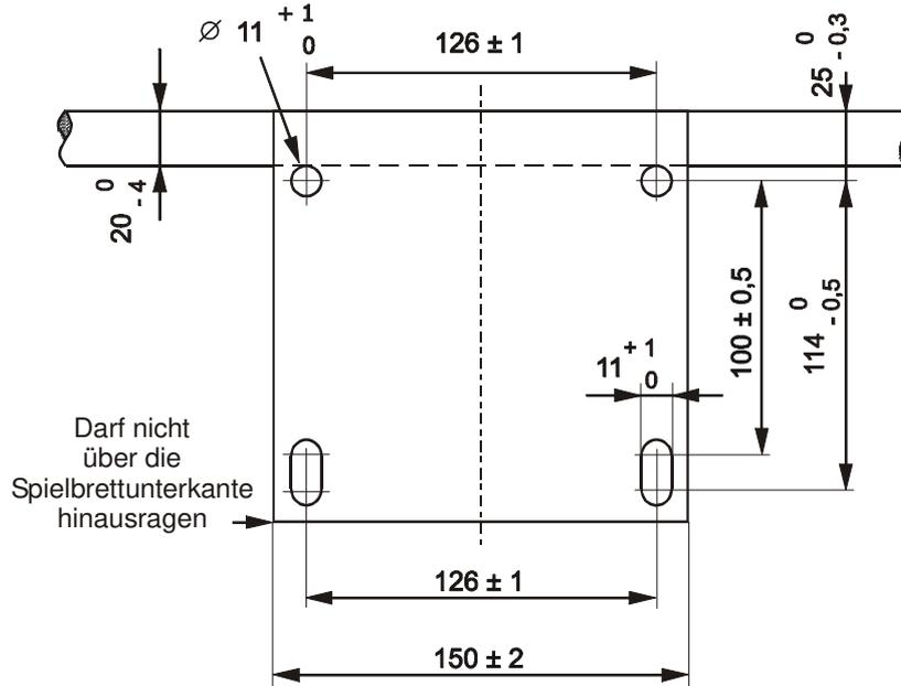
**Bild 5 Montageplatte des Rings**
